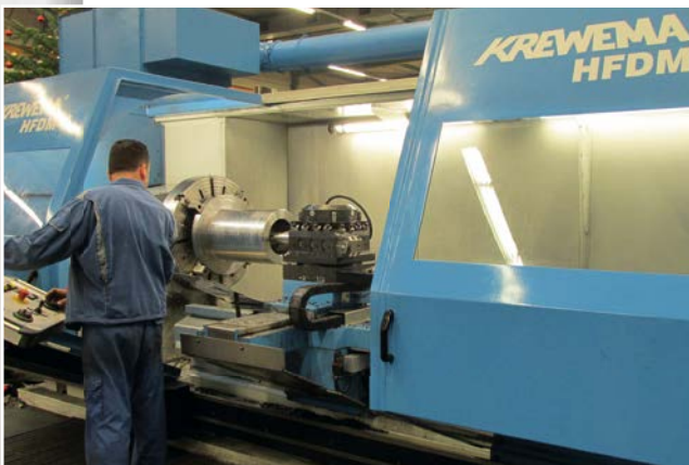
KREWEMA HFDM 45 Drehbereich bis max. 1.600 mm
