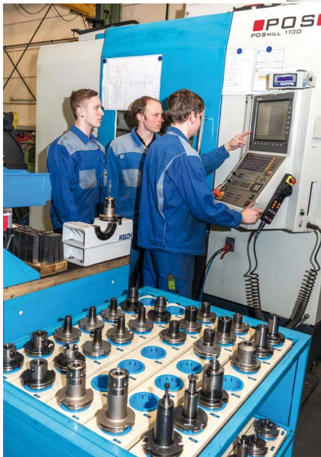
Modernes CNC-Bohr- und Fräszentrum für die Ausbildung
