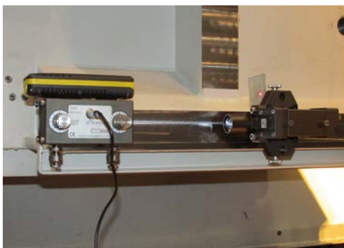
STATUS-PRO - Geradheits-Laser-Meßsystem PRO-Line
