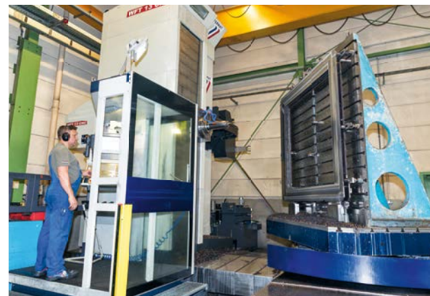
FERMAT – Bohrwerk WFT 13 X 4.000 mm Z 2.500 mm
