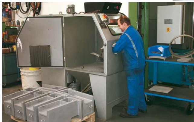
Glasperl-Strahlen für Bauteile der LEBENS-MITTEL-, OPTIK- und VAKUUM-Technik.
