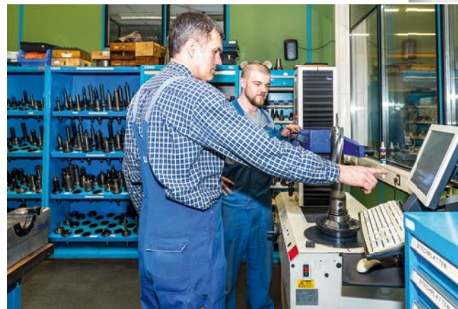
Werkzeug-Voreinstellung - seit Jahren bei der Werkzeug-Vorbereitung nicht wegzudenken
